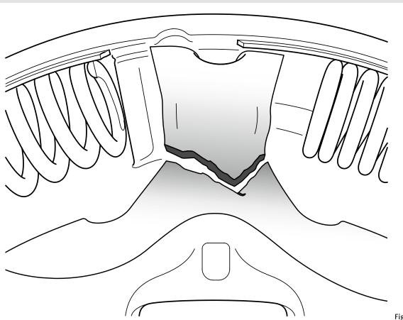
BROKEN FLANGE VANE IN THE DMF
